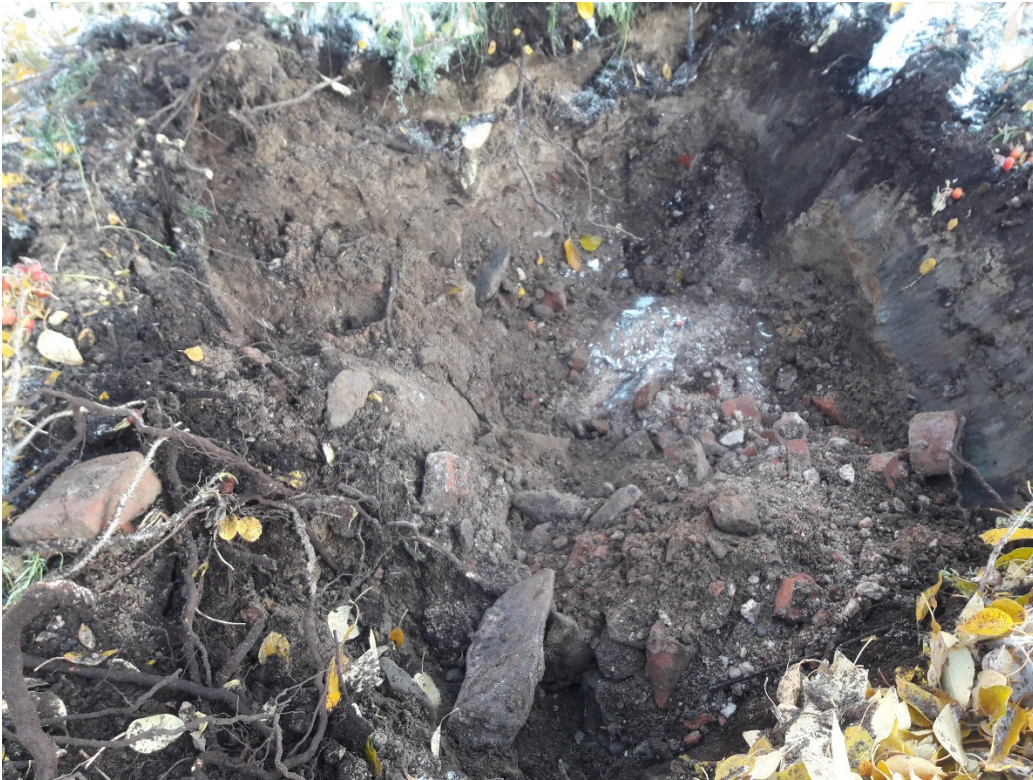
Kuva 3. Useissa koekuopissa todettiin täyttömaakerroksen seassa jätettä.
